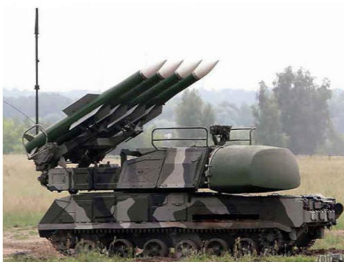
TELAR mit Radar 9A310
