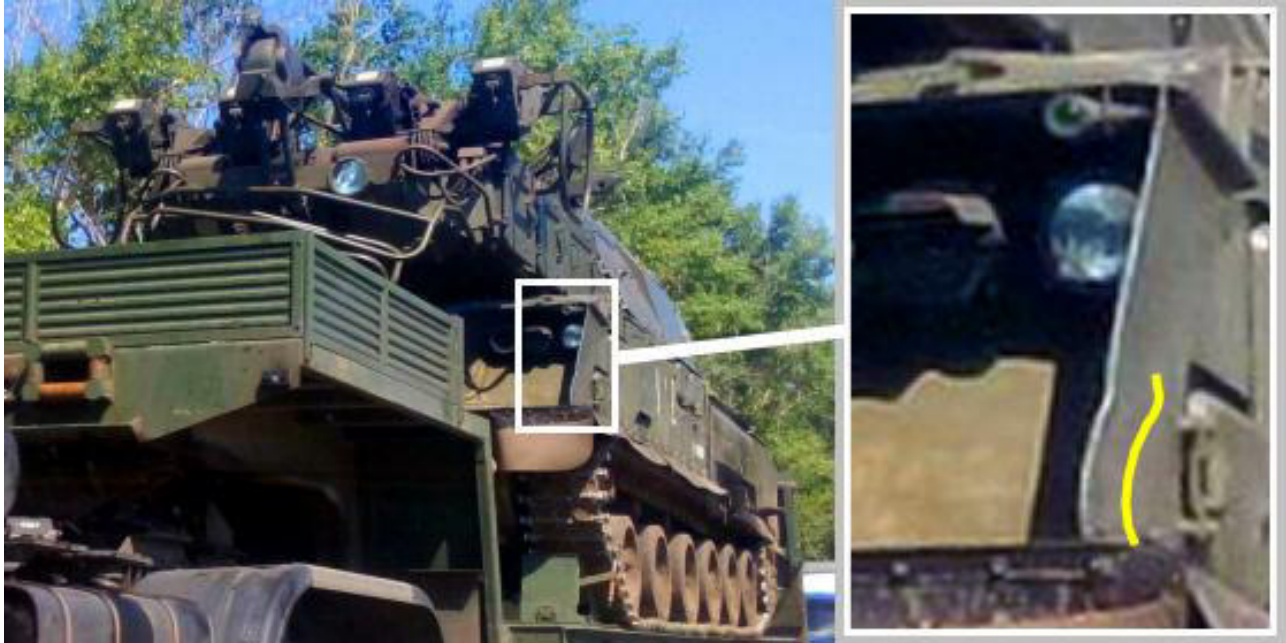
Buk 3x2 – Delle am Seitenblech 36
