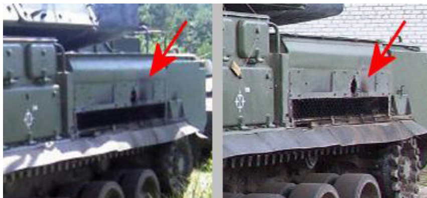
«Бука 332»: копоть над выхлопным отверстием установки (крупные планы с фотографий) 61 62
